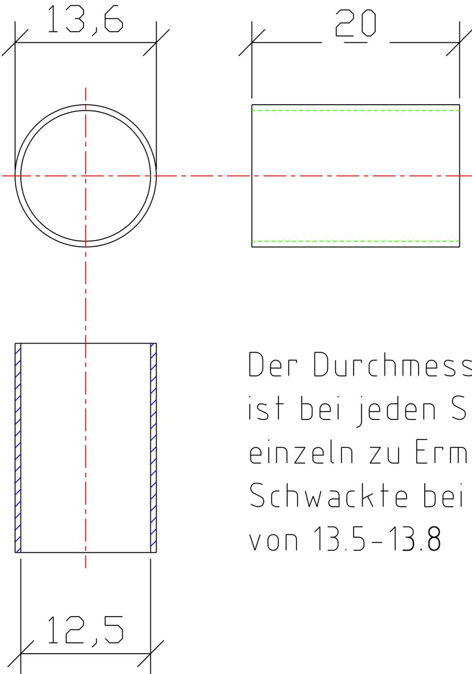
Der Durchmesser 13.6 ist bei jedem Schieber einzeln zu Ermitteln. Schwackte bei mir von 13.5-13.8
